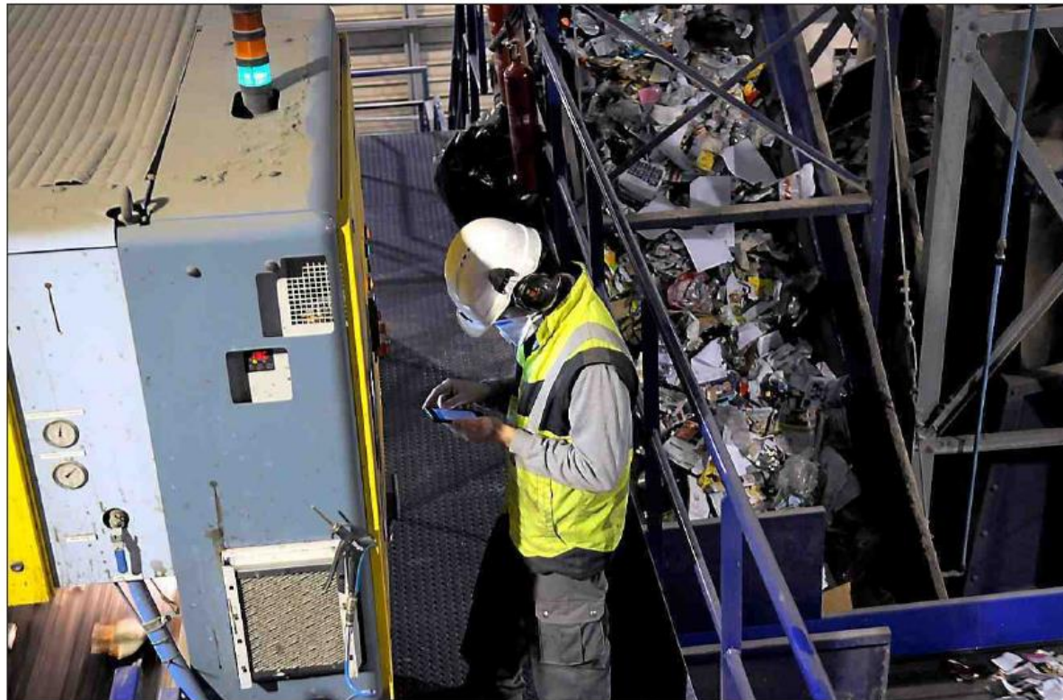
■ Les trieurs optiques distinguent les différents plastiques pour mieux les recycler et en plus grande quantité. Photos LYDIA CHASSIER
